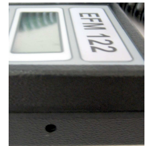
Taster „H“ zur Abstandsänderung (nur mit Schraubendreher o.ä. zu betätigen)
